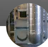
Waste container with displacement to silo Pojemnik na odpady z opróżnianiem do silosu
