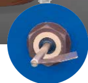
Sensors for min and max waste volume in hopper Czujnik wysokiego i niskiego poziomu odpadów w leju zasypowym
